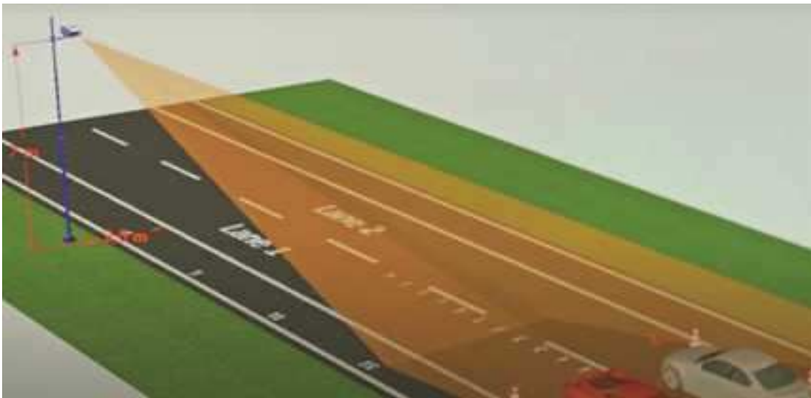
Hình 13 - Hình ảnh minh họa vị trí lắp đặt camera đo tốc độ
